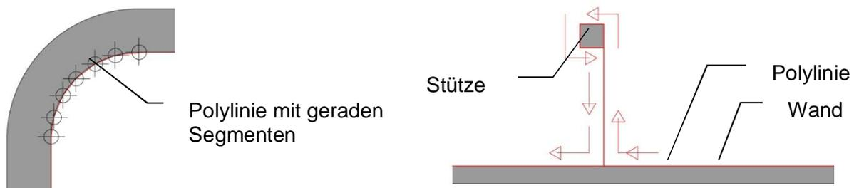
Abbildung 17: Polygone ohne Bögen und Einbinden von Stützen in Polygone
